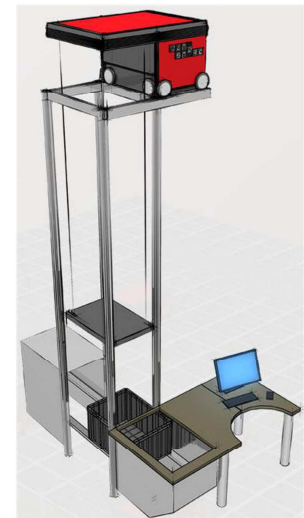
b) Detailansicht einer Auslagerstation
