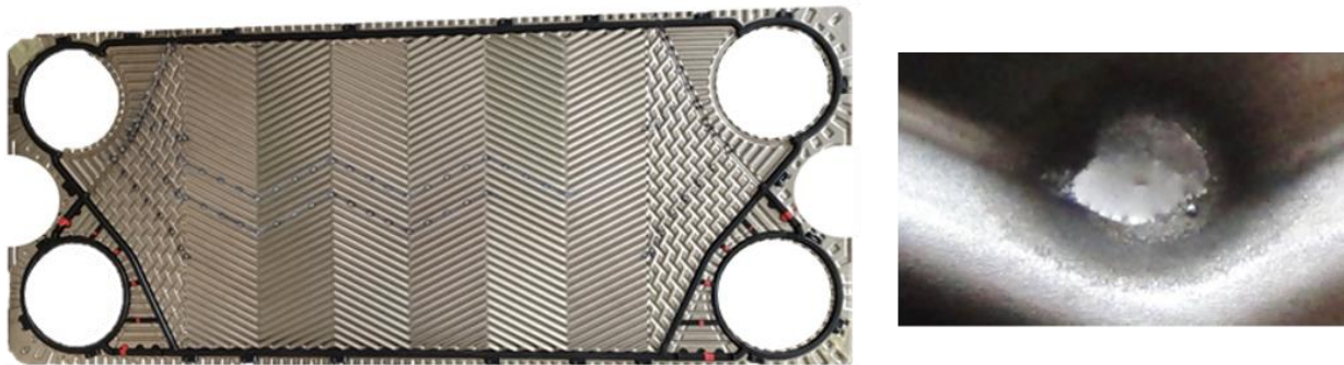
Abbildung 6.4: Links: Plattenkassette mit aufgebrachtener Nickelbeschichtung, Rechts: Detailaufnahme eines Beschichtungspunktes (dunkelgrau) mit Lot (silber)
