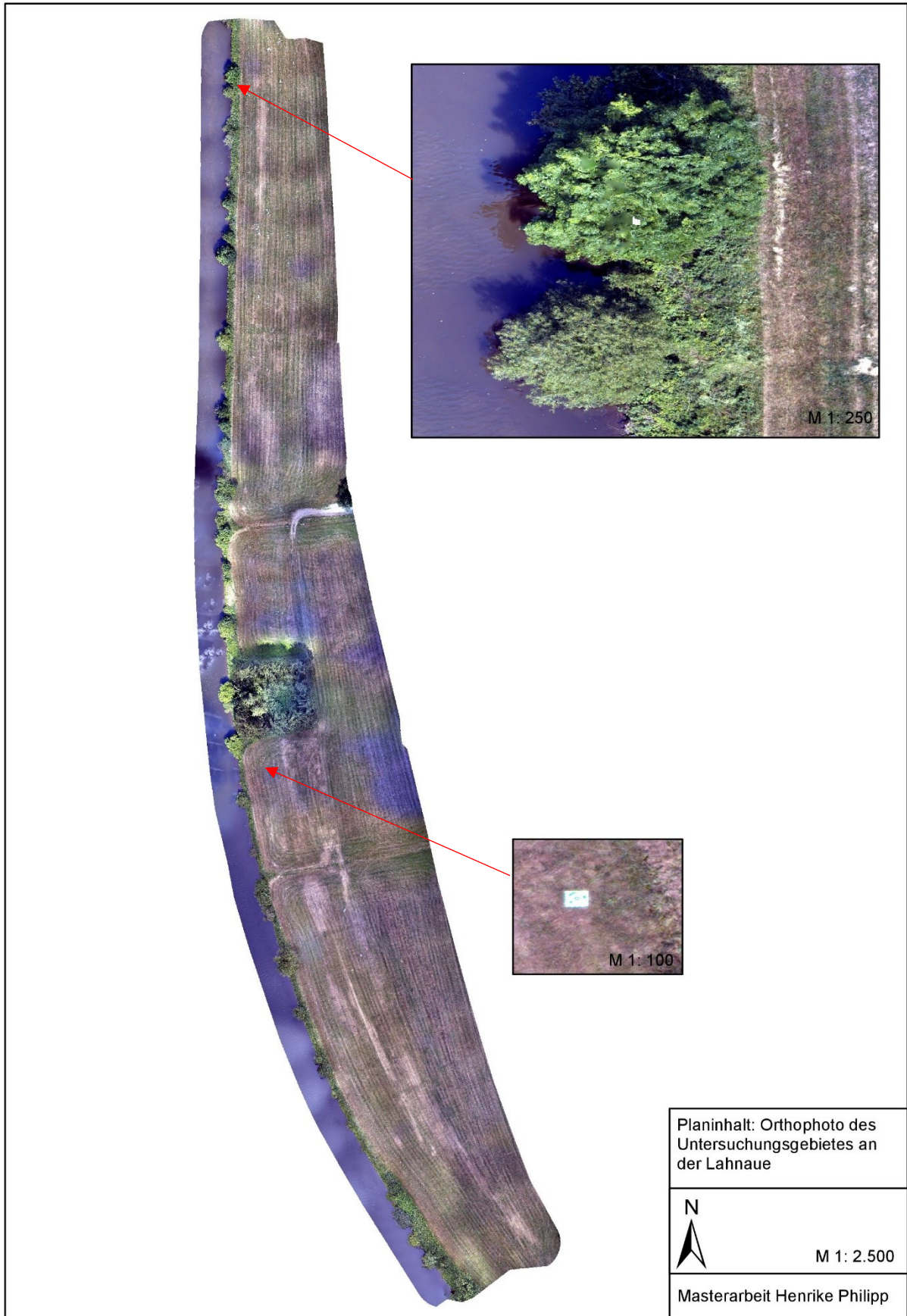
Abb. 13: DOP der Lahnaue (links) mit zwei Detailausschnitten (rechts oben: Esche ( Fraxinus excelsior ) und Bruchweide ( Salix fragilis ), unten rechts GCP)
