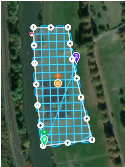
Abb. 4: Planung der Flugroute mit der Anwendung „Dronelink“ im UG
