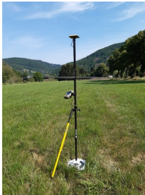
Abb. 9: Ausgerichteter GNSS-RTK-Empfänger beim Vermessen des GCP (rechts)
