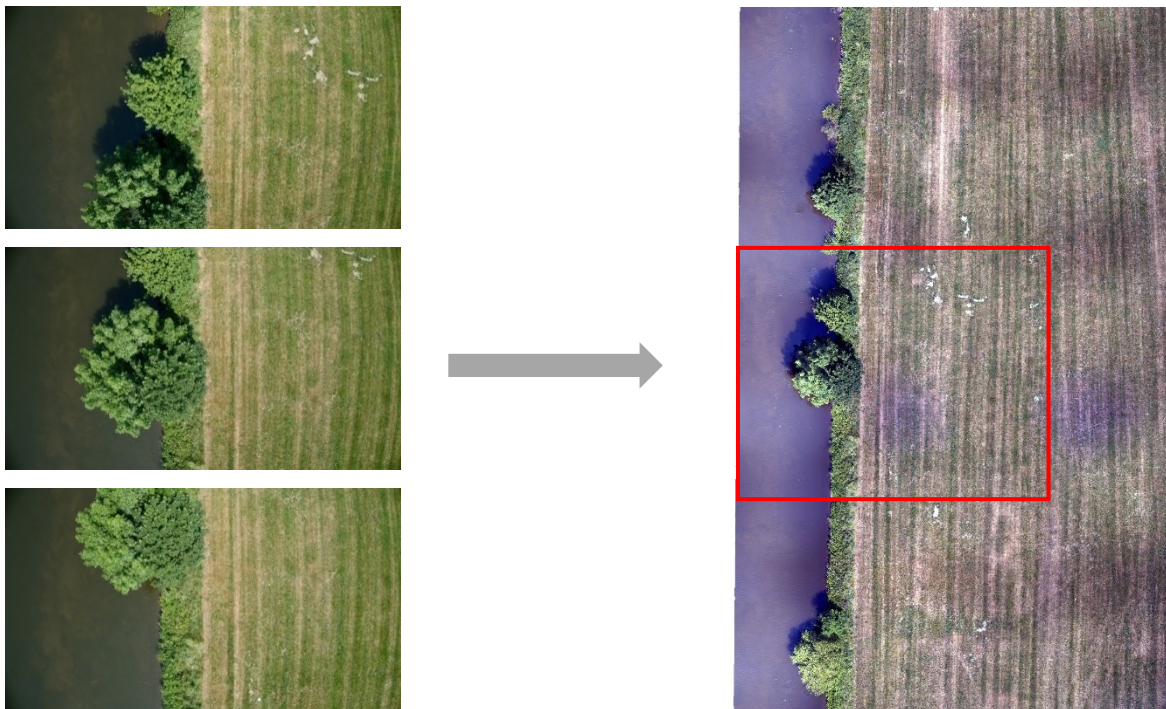
Abb. 12: Einzelne Luftbildaufnahmen mittel Structure from Motion (SfM) Methoden zusammengefügt zum Orthophoto (Ausschnitt)
