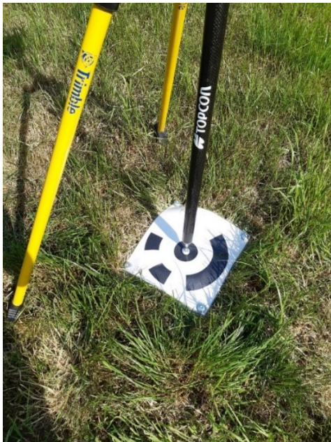
Abb. 8: GCP (laminiertes Papier), fixiert mit Nägeln (links)
