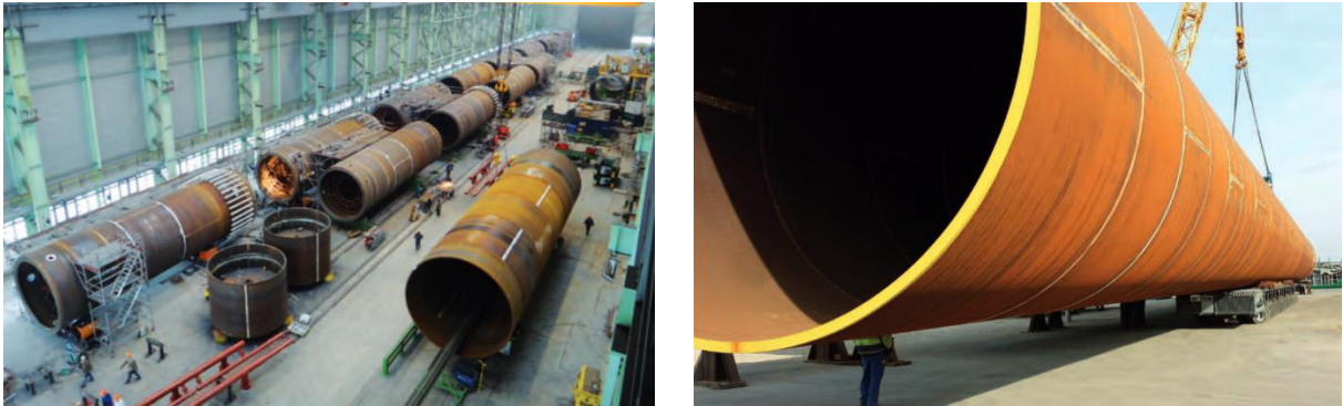
Abb. 2-2. Fertigung von Monopiles bei EEW SPC, Quelle: Wind-Kraft - German Offshore, 12/2014
