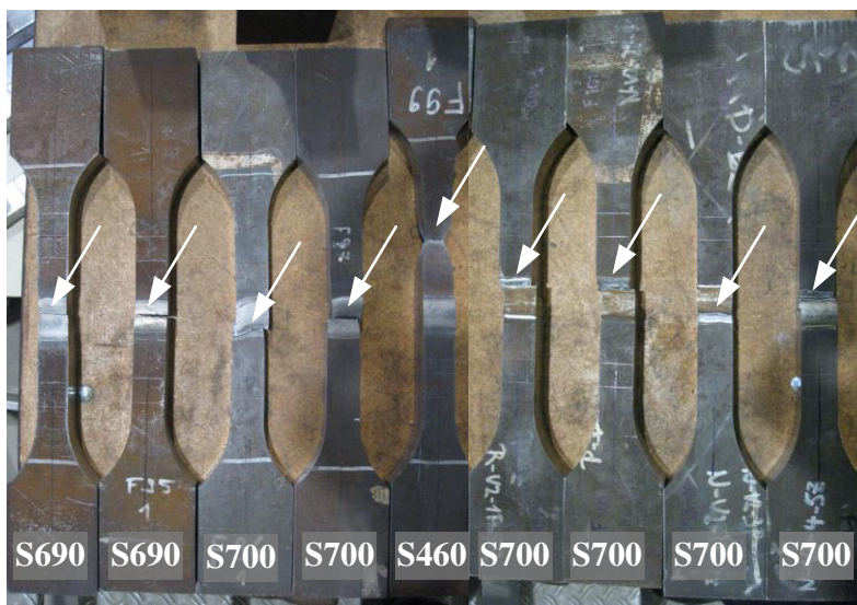
Abb. 3-12. Versuchskörper nach dem Zugversuch a) Versagensorte und b) Bruchflächen
