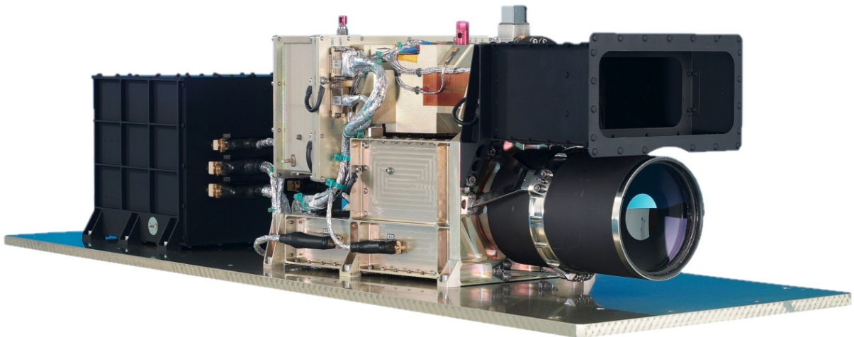
Abbildung 2.5. Die High Resolution Stereo Camera (HRSC); Quelle: DLR, 2019
