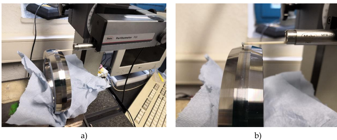
Abbildung 4.4 – Messung der Rauheit im Tastschnittverfahren. a) Perthometer; b) Messung der Rauheit in Querrichtung
