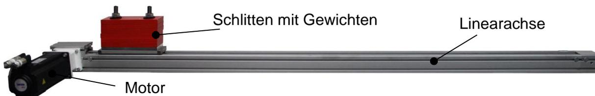
Bild 3.1: Mechanische Komponenten des Einzelachs-Prüfstands
