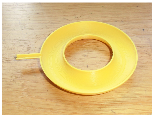
Abb. 3.2: 3D-gedruckter Halbtorus aus ABS. Zwei Hälften können zu einem Torus zusammengesetzt werden. Hohler Stiel (links) zur späteren Befestigung im Galvanisierungsbecken und zum Durchführen von Draht für elektrische Wicklungen.
