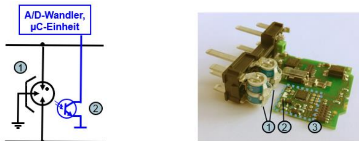
Bild 7: ÜsAg mit Auswerteschaltung (links Schaltbild, rechts Platine); (1) ÜsAg mit thermisch aktiviertem Kurzschlussmechanismus; (2) Phototransistor; (3) Mikrocontroller-basierte Auswertung
