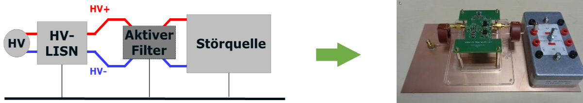
Abbildung 5: Realisierung der Testschaltung zur Verifikation der Filterwirkung
