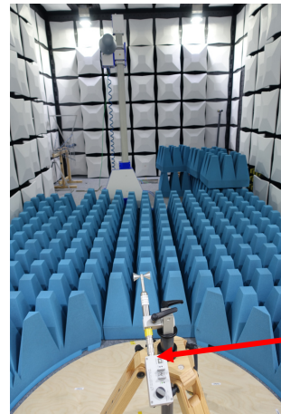
Bild 7: Gemessene elektrische Feldstärke beim Höhenscan (Absorber gemäß Validierung der Kammer)
