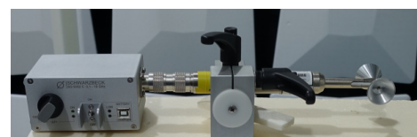
Bild 1: Kammgenerator mit bikonischer Antenne
