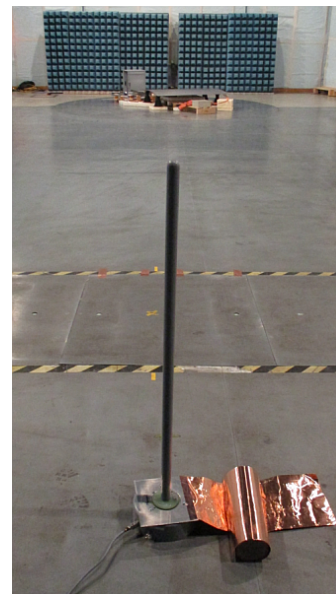
Bild 12: Messung der feldgebundenen Störaussendung mit der Rahmenantenne und dem Monopol
