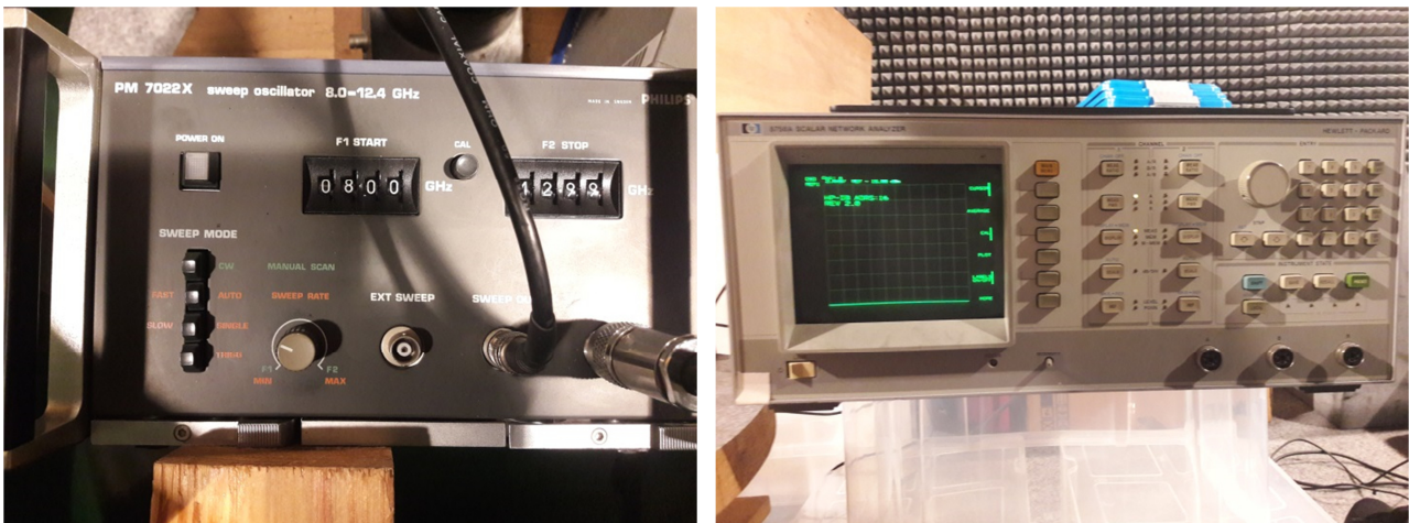
Bild 1: a) Wobbelsender und b) Skalärer Netzwerkanalysator in der EMV-Kabine.
