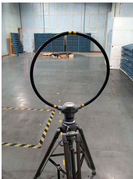
Bild 12: Messung der feldgebundenen Störaussendung mit der Rahmenantenne und dem Monopol
