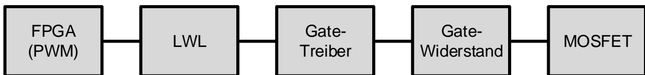
Bild 3: Blockschaltbild einer Ansteuerkette für einen Leistungstransistor
