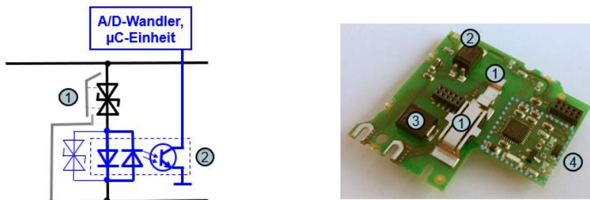
Bild 6: TVSD mit Auswerteschaltung (links Schaltbild, rechts Platine); (1) TVSD mit thermisch aktiviertem Kurzschlussmechanismus; (2) Optokoppler; (3) TVSD für Auswertung; (4) Mikrocontroller-basierte Auswertung
