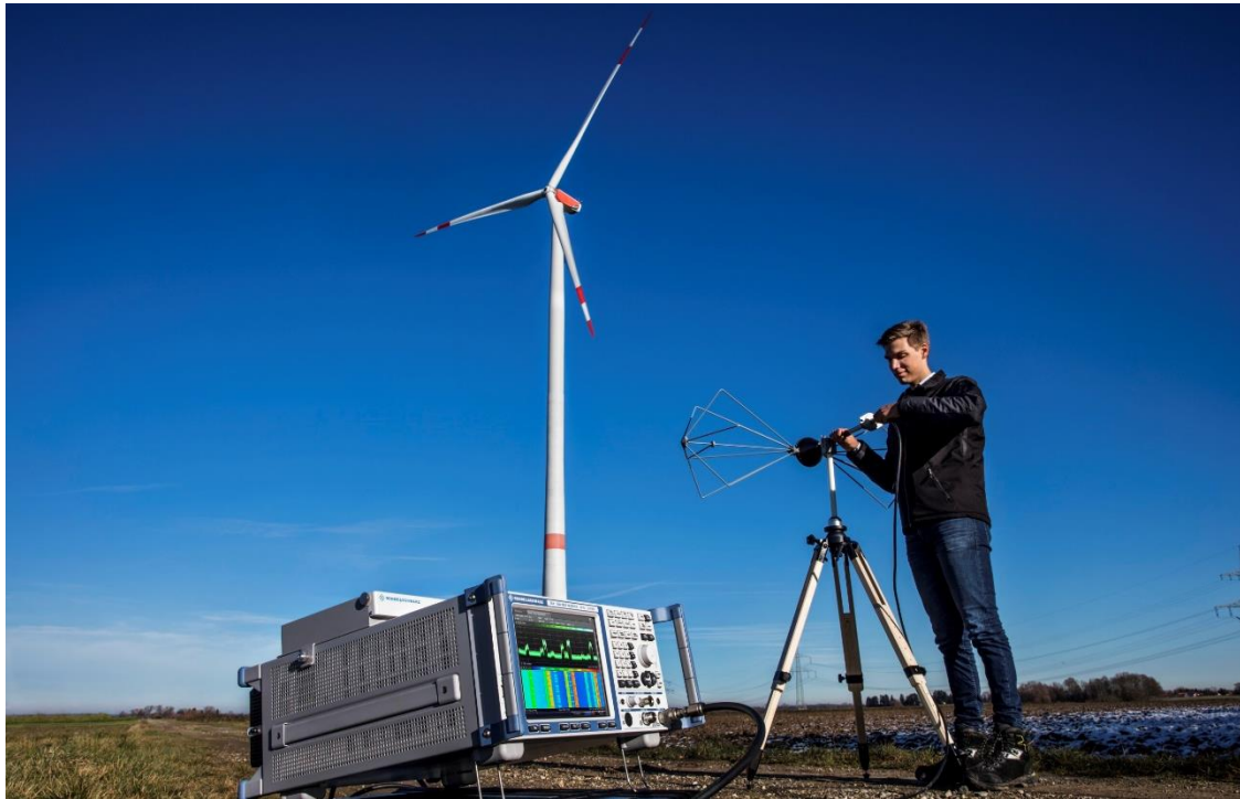
Bild 1 Messsetup für in-situ Messung des elektrischen Feldes an einer Windkraftanlage.
