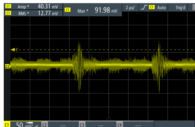
Bild 3: Spannungsverlauf am Bordnetz, Fahrzeugmotor an, Oszilloskop in AC-Kopplungsmodus. © 2020 IEEE. Reprinted, with permission, from [1].
