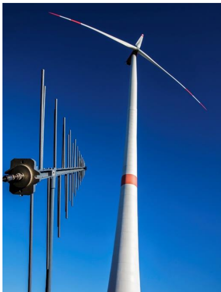
Bild 2 E-Feld Messung mit R&S®HL223 Antenne gerichtet auf Windkraftanlage.
