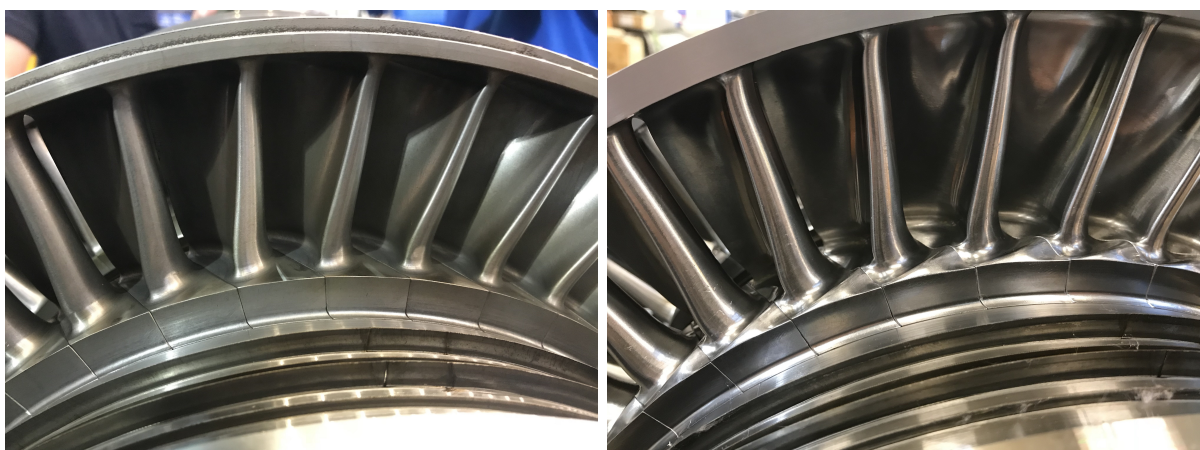
Abbildung 4.4: Vergleich der untersuchten Laufschaufeln, links: Referenzbeschaufelung, rechts: optimierte Beschaufelung
