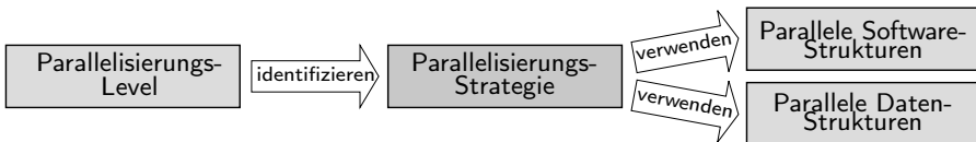
Abbildung 2.2: Der Parallelisierungsprozess beginnt bei der Identifizierung des Parallelisierungs-Niveaus (z.B. Task- oder Datenparallelität), um daraus eine geeignete Parallelisierungs-Strategie abzuleiten. Die parallele Implementierung wird dann mithilfe von parallelen Software-Strukturen, parallelen Algorithmen und parallelen Datenstrukturen, Datenzugriffsmustern oder manuellen Synchronisationen realisiert.
