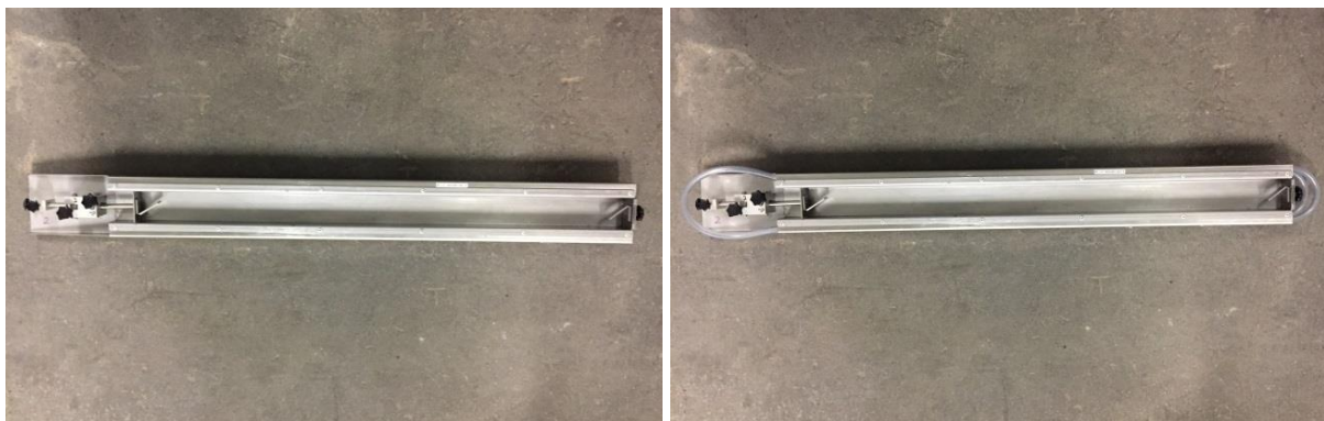
Abbildung 3-9: herkömmliche Schwindrinne (links), mit Kühlsystem ausgestattete Schwindrinne (rechts)
