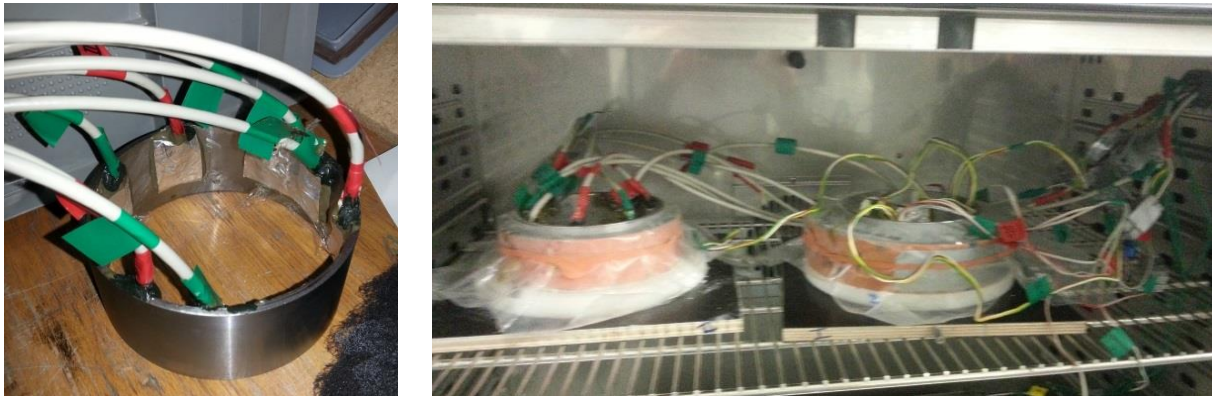
Abbildung 3-10: Schwindring mit installierter Messsensorik (links), Anordnung zweier Schwindringe im Klimaschrank (rechts)
