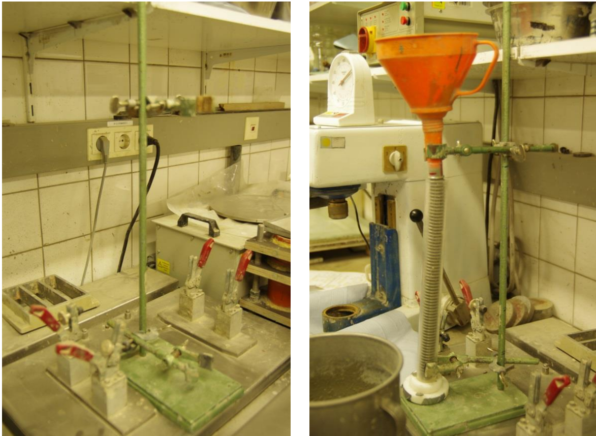
Abbildung 3-4: Vibrationstisch mit Halterung (links) zum Verfüllen der Schwindschläuche mit Hilfe eines Trichters (rechts)
