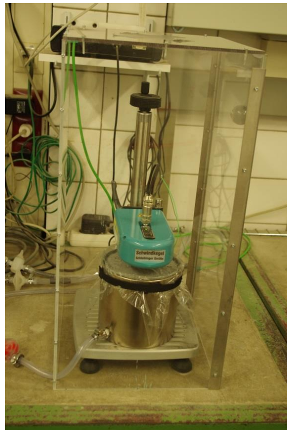
Abbildung 3-6: Befüllen des Kegels mit Hilfe einer Rutsche (links), Plexiglaskubus zum Schutz vor Temperaturschwankungen im Raum (rechts)
