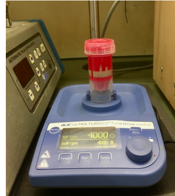
Abbildung 5.14: Herstellung einer Lackformulierung mit dem Farbstoff Lumogen® F305 rot .
