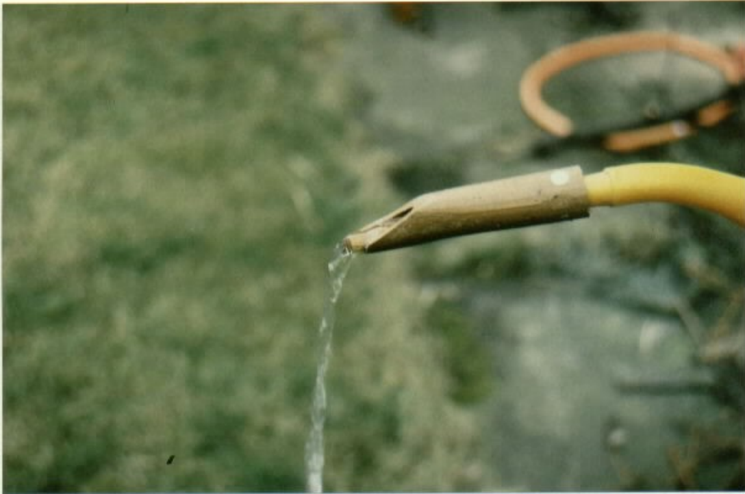
Kat.Nr.: 2646 Röhrentülle, Gießversuch mit wenig Wasser: einwandfreies Gießverhalten
