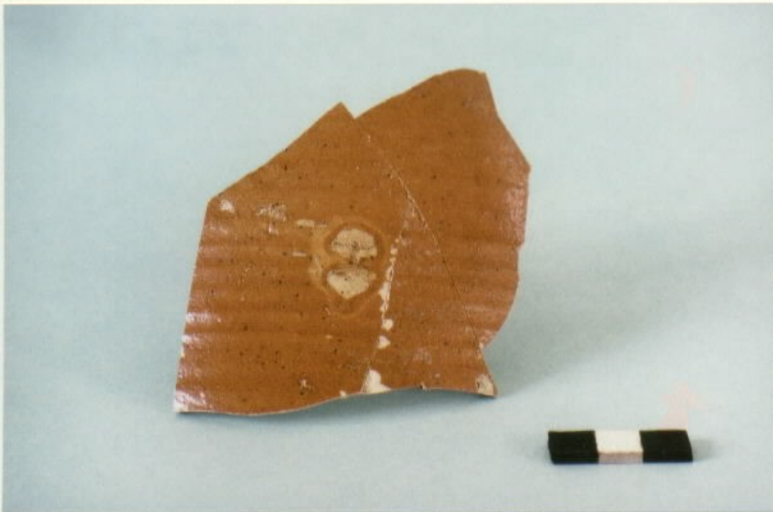
Kat.Nr.: 2343 Mit Anflugglasur überzogene Stapelspur, Gefäß wahrscheinl. beim Brand verkippt
