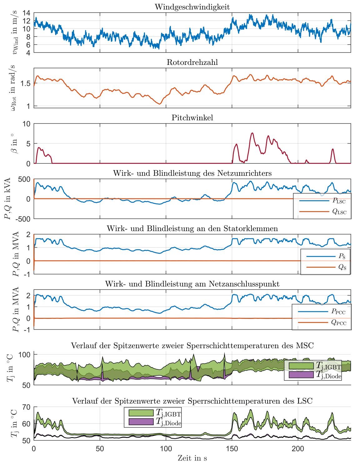
Abbildung 4.30: Zeitverläufe des grundlegenden Gesamtmodells mit DGASM und stochastisch variierender Windgeschwindigkeit sowie einem kapazitiven \cos(\varphi) von 0,95 am PCC bei Blindleistungsbereitstellung rein über den MSC
