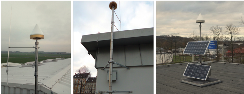
Abbildung 6: GNSS-Monitoring-Referenzstationen, von links nach rechts: Flughafen Essen-Mühlheim und Pumpstation BO-Dahlhausen, Feuerwehr Essen-Kupferdreh (temporär)
