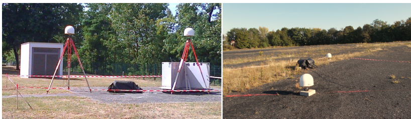
Abbildung 10: Links: Aufbau der Standpunkte 0971 über dem Doppel-CR und Punkt 0988 links daneben. Rechts: Standpunkte 0971 (vorne) und Punkt 0988 (hinten) auf Bodenplatten.
