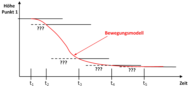
Abbildung 15: Höhenverhalten eines Punktes, beschrieben durch eine Abfolge von festen Höhenwerten oder durch ein zeitliches Bewegungsmodell.
