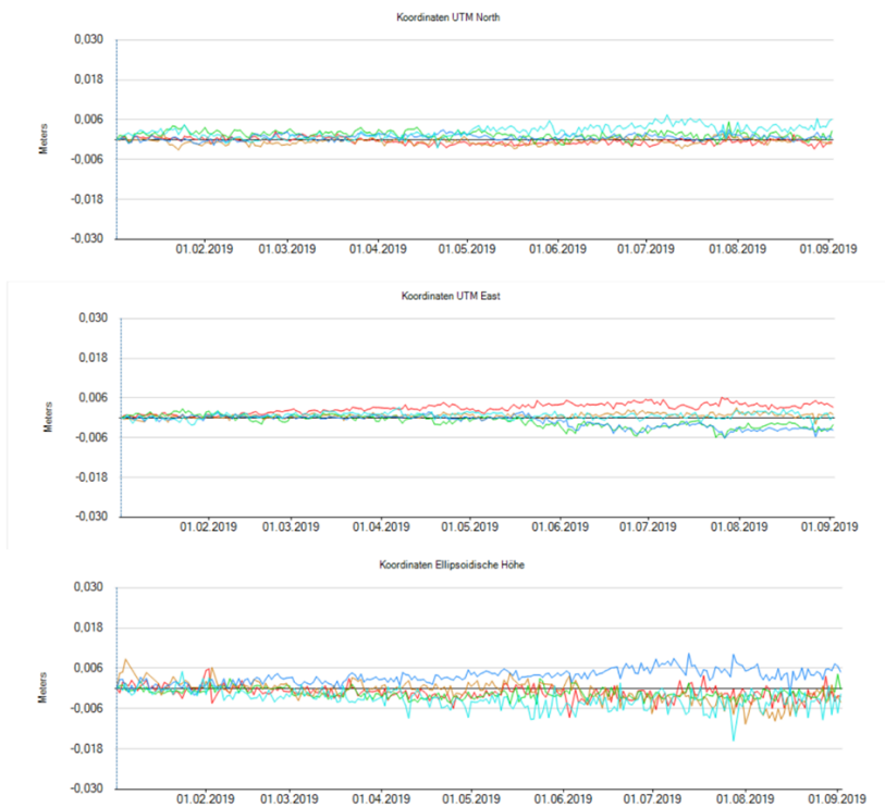
Abbildung 12: UTM-Koordinatenzeitreihen (Differenzen) einiger ausgewählter Referenzstationen des RAG FuE-Netzes bei Auswertung mit der Geo++ Post-Processing Software
