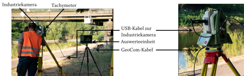
Abbildung 1: Komponenten des modularen Digitalkameratachymeters und deren Aufbau (links), Detailansicht Kamera (rechts)
