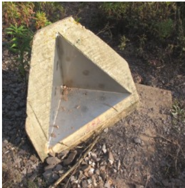
Abbildung 2: Radarreflektor für das Langzeitmonitoring in der Umgebung des Hochmoselübergangs (links), Stahlbrückendetail der Honsellbrücke (Frankfurt am Main) mit der Funktion eines Radarreflektors (rechts)
