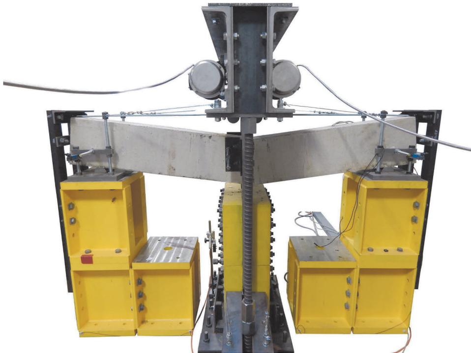
Abbildung 7.11: Realisierter Versuchsstand zur Untersuchung des Ermüdungsverhaltens von Stahlbetonbalken im Very-High-Cycle-Fatigue-Bereich (nach Versuchsende)
