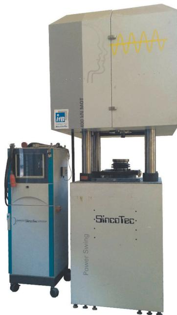
(a) Resonanzprüfmaschine des Instituts für Baustoffe an der Leibniz Universität Hannover vom Typ *Power Swing* der Firma SincoTec
