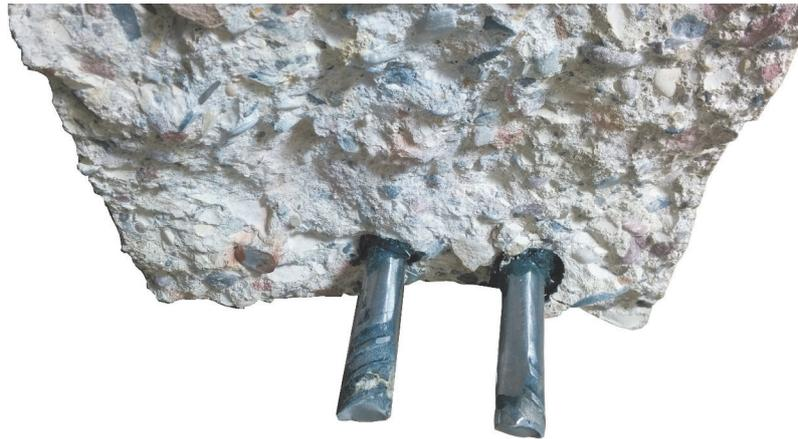
Abbildung 7.15: Gerissene Bewehrung des Stahlbetonbalkens
