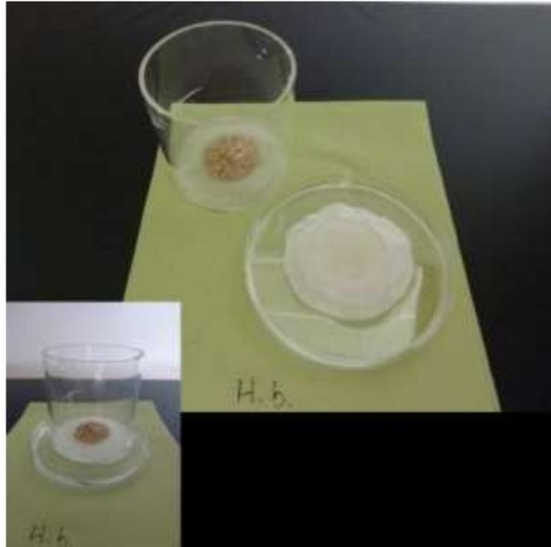
**Abb. 1:** Modifiziertes White Trap-Verfahren zum Extrahieren der Nematoden aus dem Präparat.
