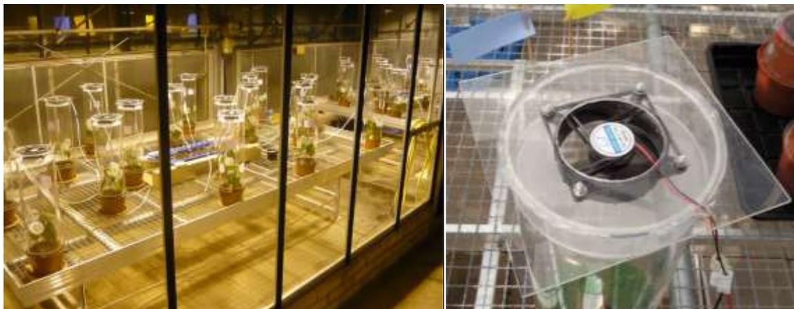
**Abb. 7 & Abb. 8:** Laufendes Mikrokosmos-Experiment / Zylinder mit aktivem Belüftungssystem in einer Gewächshauskabine (siehe Anhang).
