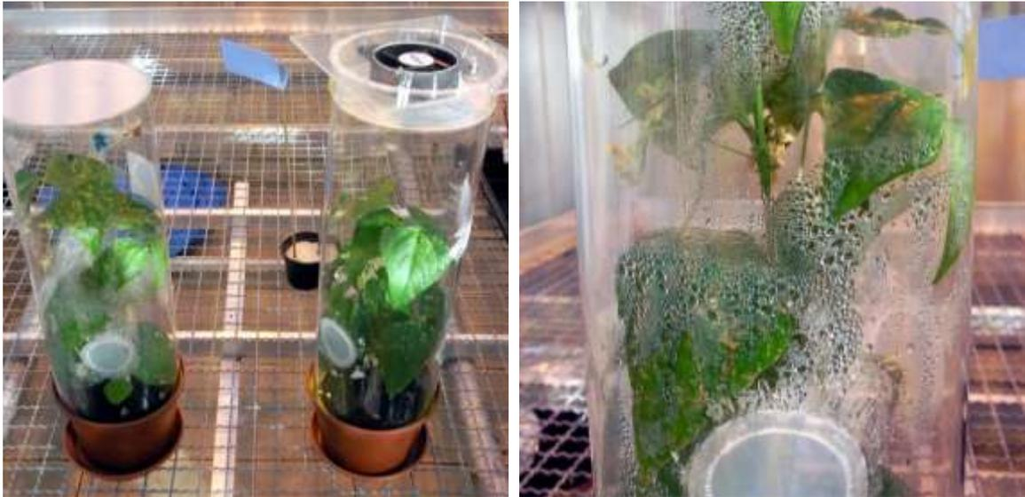
**Abb. 56 & 57:** links: Acrylglaszylinder ohne (links) und mit Belüftungssystem (rechts), rechts: Zylinder ohne Belüftungssystem in der Vergrößerung: Kondenswasser durch hohe Luftfeuchte deutlich sichtbar.
