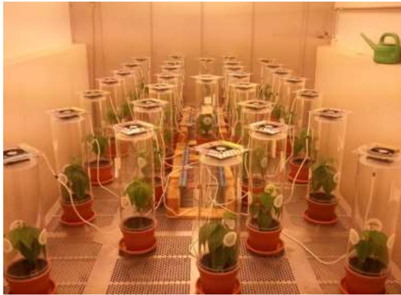
**Abb. 12:** Laufendes Mikrokosmos-Experiment (Zylinder mit aktiven Belüftungssystem in einer Klimakammer).
