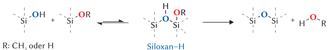
Abbildung 4.92 Reaktionsschema für die Kondensation einer Silanolgruppe ( blau markiertes Sauerstoffatom ) mit einem Alkoxy silan oder Silanol ( rot markiertes Sauerstoffatom ) zum Siloxan und Alkohol, respektive Siloxan und Wasser. Der Übergangszustand wird durch die Anlagerung der angreifenden Silanolgruppe an das Siliciumatom des Reaktionspartners gebildet, die Bindungsordnungen aller drei Bindungen am Sauerstoffatom sind > 0.5. Formalladungen sind nicht bestimmt und daher nicht angegeben.
