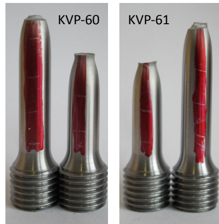
Abb. B.02: Getestete Zugproben des KVP D30 (nicht maßstäblich)
