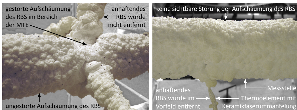
Abb. 3.12: Detail des Versuchskörpers U91 nach dem Brandversuch (links: Bereich des Messquerschnittes 1; rechts: Bereich des Messquerschnittes 2)
