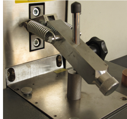
Abb. 4.04: Untersuchte Rundprobe am Funken-Emissions-Spektrometer (FES)
