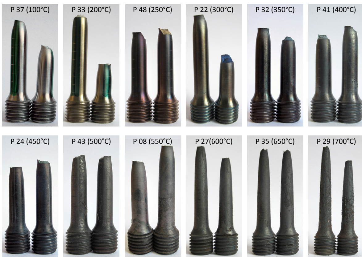
Abb. 4.27: Auswahl von Fragmenten der unter erhöhter Temperatur getesteten Zugproben (Abbildungen sind nicht maßstäblich)
