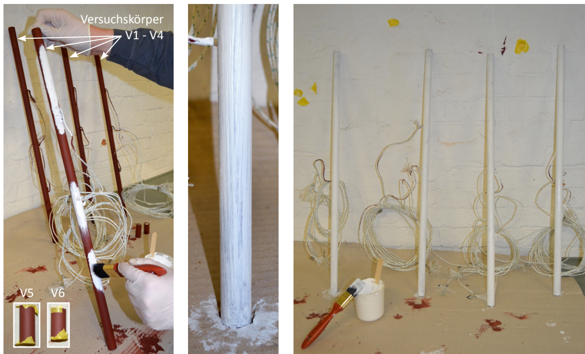
Abb. 3.04: Applikation des reaktiven Brandschutzsystems auf die grundierten Versuchskörper V1 - V4
