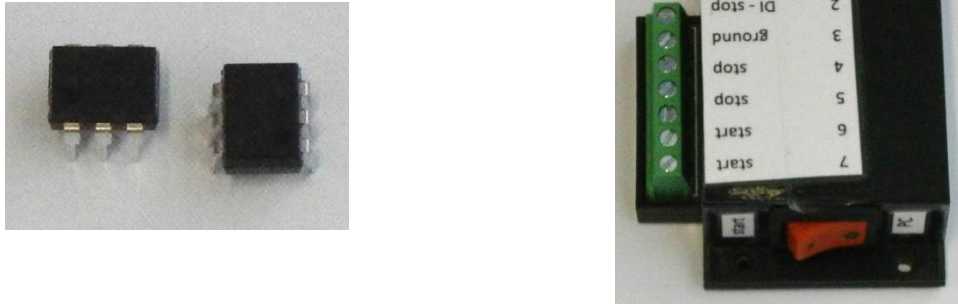
Abb. 44: Verwendetes Photomos (links) und fertiger Schaltkasten (rechts).
