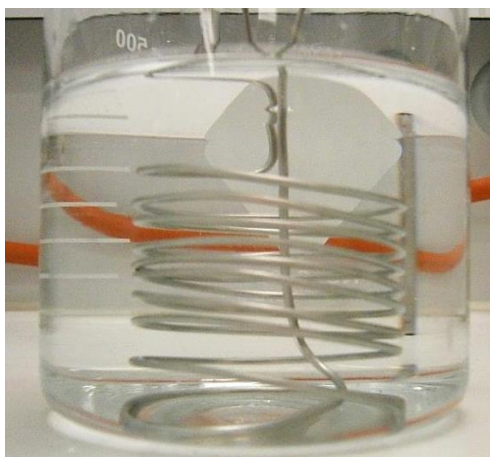
Abb. 25: Bild eines simplen Wärmetauschers für ein Durchflusssystem.
