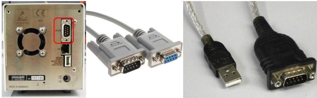
Abb. 42: RS-232 Anschluss an einer KNAUER HPLC-Pumpe (links), Kabel (Mitte) und RS-232 auf USB Adapter (rechts).
