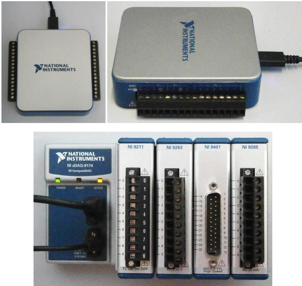
Abb. 43: Geräte USB-6001 (oben) und cDAQ-9174, mit den Modulen NI 9211, NI 9263, NI 9401 und NI 9265 (unten) von der Firma NATIONAL INSTRUMENTS.
