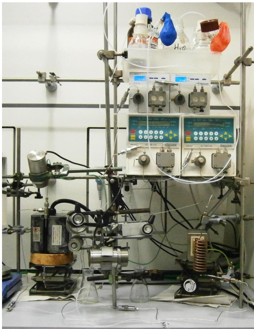
Abb. 14: Vollständiges Durchflusssystem mit vier HPLC-Pumpen, drei 6-Wege-Ventilen sowie einem Induktor für Hoch- und einem für Mittelfrequenz.
