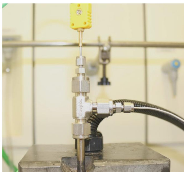
Abb. 24: Schematischer Aufbau für die Temperaturmessung mit einem K-Element innerhalb des Reaktors (links); Foto des Aufbaus (rechts).
