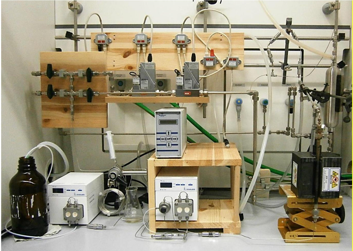
Abb. 32: Bild des Systems zur Synthese unter Hochdruck-/Hochtemperaturbedingungen mit Gasen.
