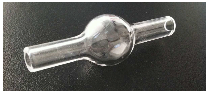
Abbildung 3.11: Fotografische Aufnahme des in der Hochtemperatur-Molekularstrahlquelle eingesetzten Quarzglasröhrchens.
