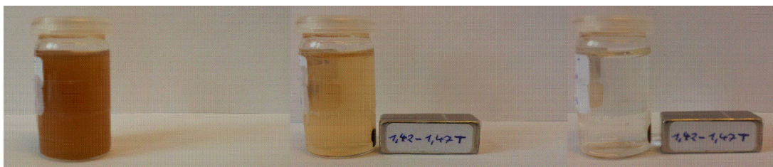
Abbildung 127: Verhalten dispergierter Dopamin funktionalisierter Magnetit-Nanopartikel in Anwesenheit eines 1,42 T Neodymmagneten. Links: ohne Magnet, Mitte: nach 2 min Exposition, rechts: nach 4 min Exposition.
