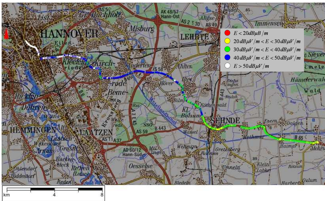
Figure 5.12: Field strength measurement of the coverage limit 4 QAM mode (code rate: 0.5) in the VHF Band III (map source: Bundesamt für Kartographie und Geodäsie)
