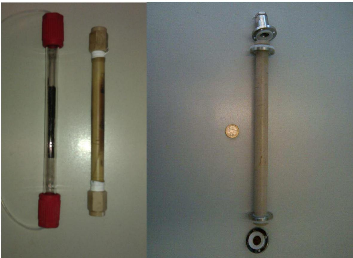
**Abbildung 7:** Reaktoren mit Verschraubungen; Glasreaktor **I** und PEEK-Reaktor **I** (links); PEEK-Reaktor **II** (rechts) Länge 31 cm, ID: 15 mm, AD: 20 mm.
