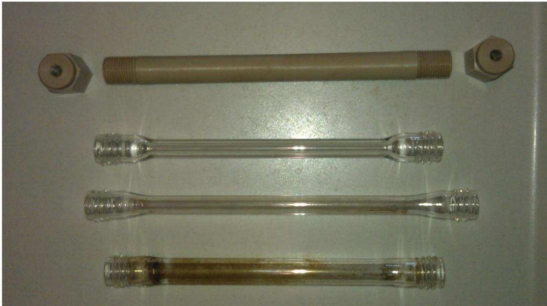
**Abbildung 6:** Glas und PEEK-Reaktoren; von oben nach unten: PEEK-Reaktor **I** Heizzone: 12 cm, ID: 8.5 mm, AD: 11.0 mm; Glasreaktor **III** Heizzone 12 cm, ID: 5.3 mm, AD: 8.0 mm; Glasreaktor **II** Heizzone 12 cm, ID: 6.5 mm, AD: 8.0 mm; Glasreaktor **I** Heizzone 12 cm, ID: 8.5 mm, AD: 11.0 mm.
