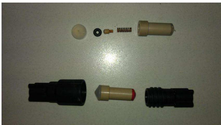
**Abbildung 10:** Rückdruckventil der Firma IDEX (früher UPCHURCH) mit Innenleben.
