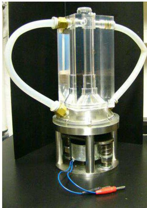
Abbildung 4.2: Kompartiment für die PIV-Aufnahmen. Das Fluid wird durch eine Membran, die mit einem Permanentmagneten verbunden ist, ausgelenkt, sodass Fluid durch die Herzklappe gepumpt wird. Auf der rechten Seite des Silikonschlauchs ist eine Drossel angebracht, um die richtige Druckdifferenz einstellen zu können (auf dem Bild als Einschnürung im Schlauch ohne Drossel zu erkennen).
