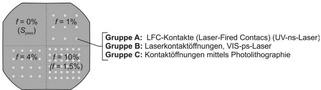
Abbildung 5.4: Aufteilung der geöffneten Flächenanteile auf den Lebensdauer-teststrukturen.
