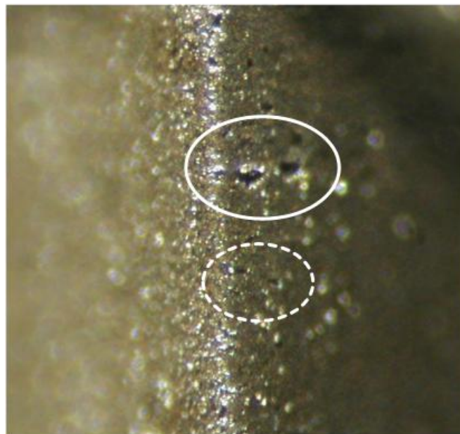
Abb. 3.8: Poren und Mikrorisse an Dichtkante nach Materialverhärtung
