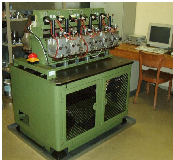
Abb. 4.8: Zwölfachprüfstand mit Mess-PC
