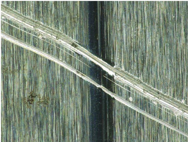
Abb. 3.10: Kratzer auf Laufspur des RWDR, Randaufwerfungen des Kratzers poliert, Leckagekanal vorhanden [39]
