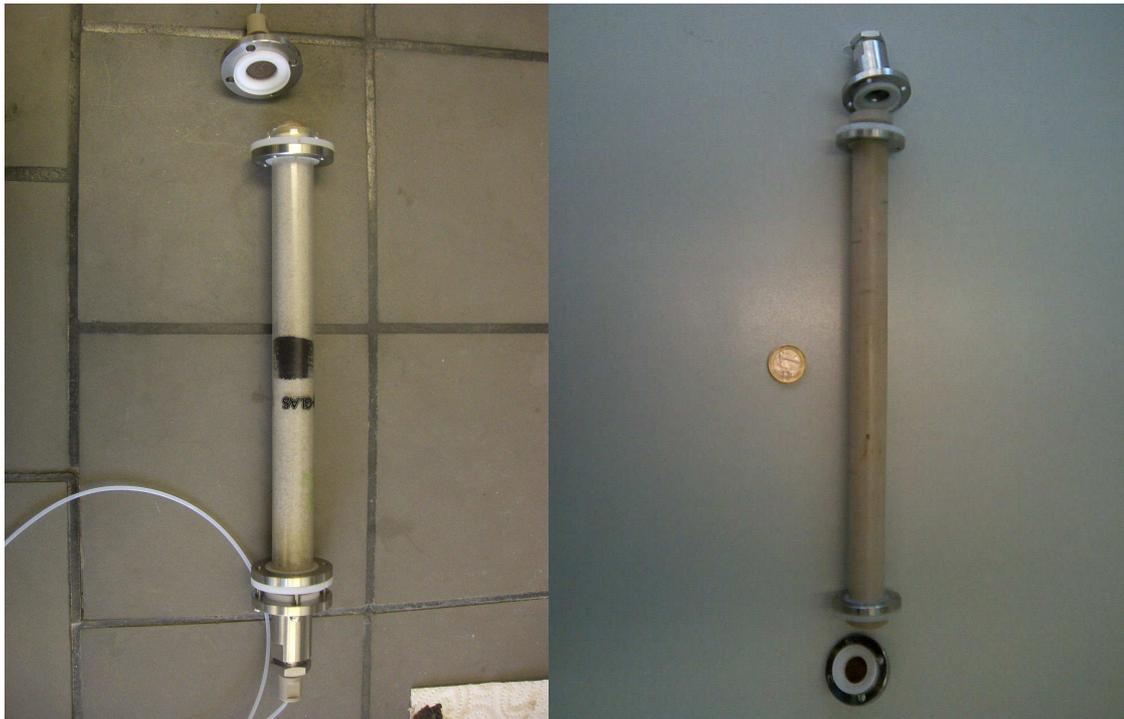
**Abb. 9:** HPLC-Säulenreaktor (links), PEEK-Reaktor II (rechts), Länge: 31 cm, ID: 15 mm, AD: 20 mm.
