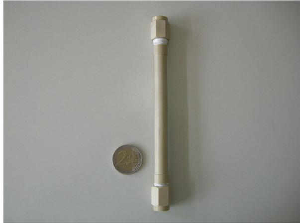
**Abb. 8:** PEEK-Reaktor **I**, Länge: 12.0 cm, ID: 8.5 mm, AD: 11.0 mm.
