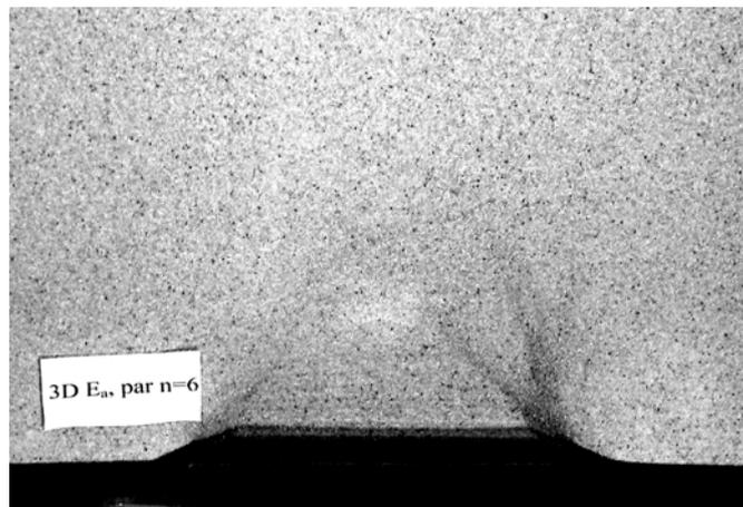
Abbildung A-4 : Bruchkörperform an der Oberfläche infolge Parallelverschiebung von  $u/h > 10 ‰$ ,
