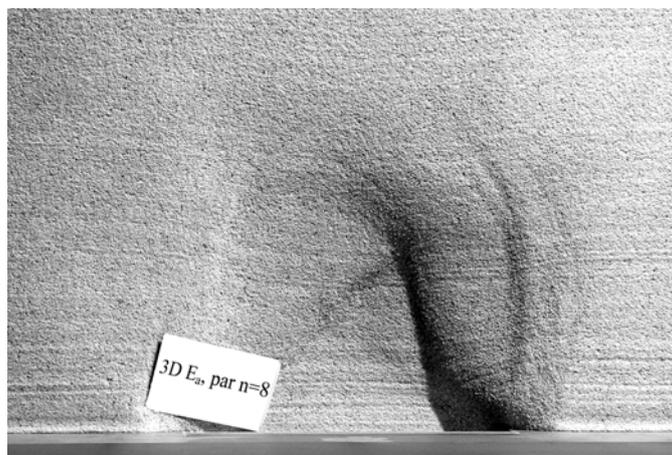
Abbildung A-7 : Bruchkörperform an der Oberfläche infolge Parallelverschiebung von  $u/h > 10 ‰$ ,
