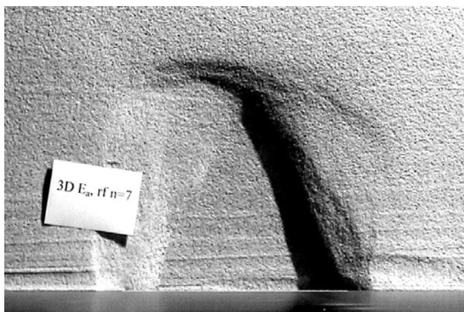
Abbildung 3-31: Bruchkörperform an der Oberfläche infolge Fußpunktdrehung von  $u/h > 10\%$ , für  $n = 7$  bei  $D = 0,38$
