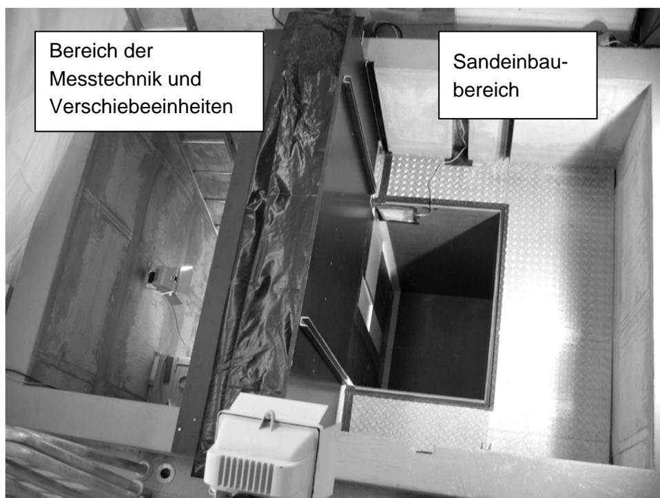
**Abbildung 3-7 : Aufsicht auf den Versuchskasten und den staubdichten Messbereich**
