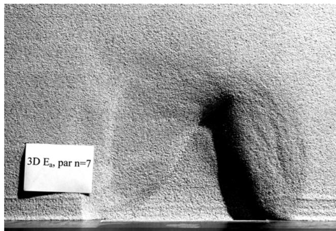
Abbildung 3-30: Bruchkörperform an der Oberfläche infolge Parallelverschiebung von  $u/h > 10\%$ , für  $n = 7$  bei  $D = 0,38$
