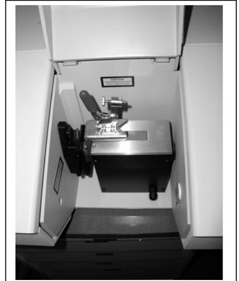
Abb. 3.2-3: Geöffnete Messkammer vom Messgerät Spectrum BX: ZnSe-Kristall in der Bodenplatte mit aufgesetztem Spannmechanismus
