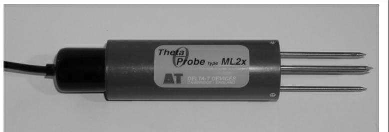
Abb.3.2-1: Theta-Probe-Bodensonde zur FDR-Messung
