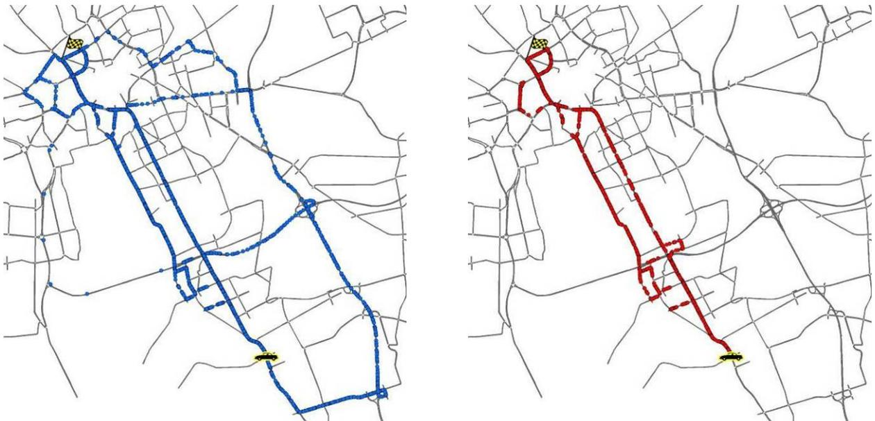
**Bild 9.47:** Routen der nicht navigierten (links) und der dyn. navigierten Pkw (rechts) der Quelle-Ziel Relation (3)–(2) bei 35 % Penetrationsrate, Störfall 2
