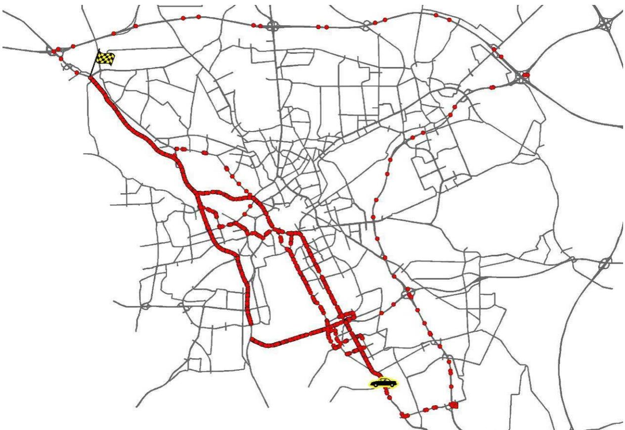
**Bild E.12:** Routen der dynamisch navigierten Pkw der Quelle-Ziel Relation (3)–(1) bei 35 % Penetrationsrate, Informationsintervall 5 min, dynamische Navigationsweise
