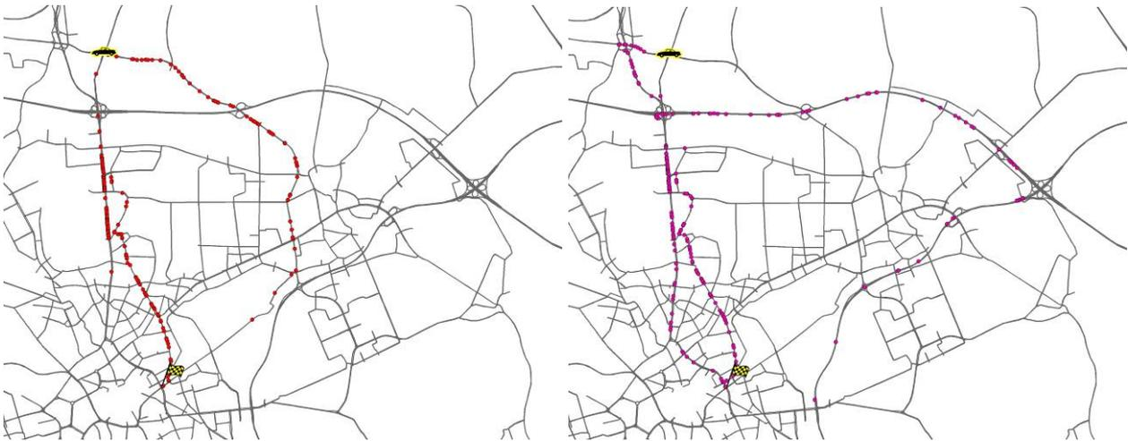
**Bild 9.61:** Routen der dynamisch (links) und der dynamisch ab einem Schwellwert (rechts) navigierten Pkw der Quelle-Ziel Relation (5)–(4) bei 35 % Penetrationsrate im Zeitraum von 8:15 bis 8:30 h, Informationsintervall 15 min, Störfall 3
