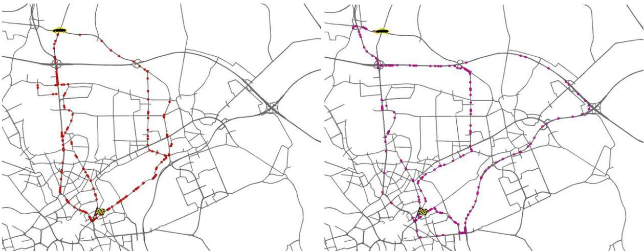
**Bild 9.62:** Routen der dynamisch (links) und der dynamisch ab einem Schwellwert (rechts) navigierten Pkw der Quelle-Ziel Relation (5)–(4) bei 35 % Penetrationsrate im Zeitraum von 8:30 bis 8:45 h, Informationsintervall 15 min, Störfall 3
