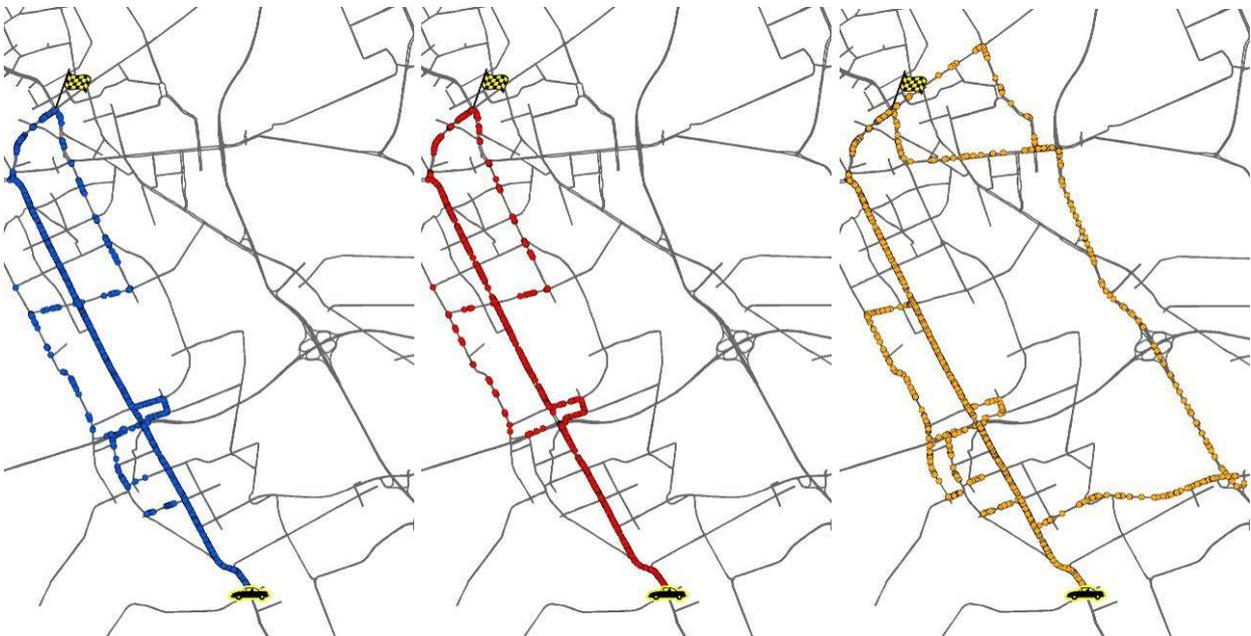
**Bild 9.35:** Routen der nicht (links), der dynamisch (Mitte) und der dynamisch nur auf dem hochrangigen Straßennetz (rechts) navigierten Pkw der Quelle-Ziel Relation (3)-(4) bei 35 % Penetrationsrate, Informationsintervall 15 min, normale Verkehrsverhältnisse
