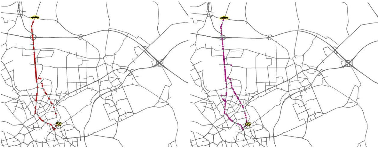
**Bild 9.60:** Routen der dynamisch (links) und der dynamisch ab einem Schwellwert (rechts) navigierten Pkw der Quelle-Ziel Relation (5)–(4) bei 35 % Penetrationsrate im Zeitraum von 8:00 bis 8:15 h, Informationsintervall 15 min, Störfall 3
