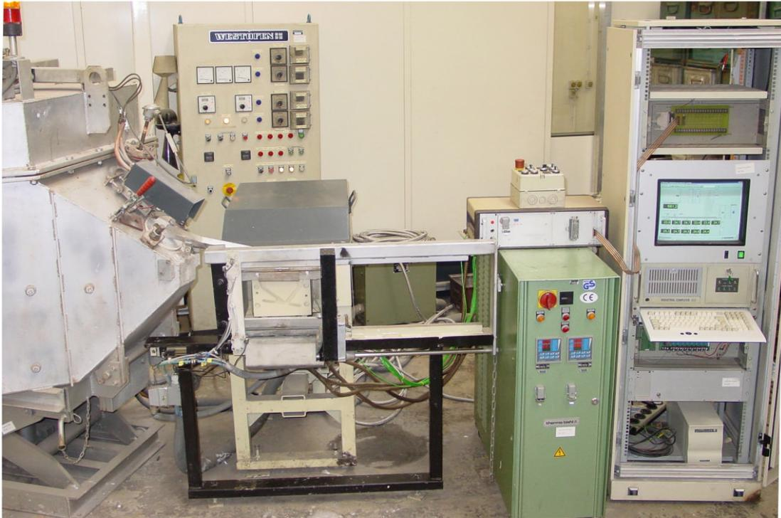
Bild 3.1: Kokillengießstrecke mit Heiz-/Kühlgerät und Messrechner
