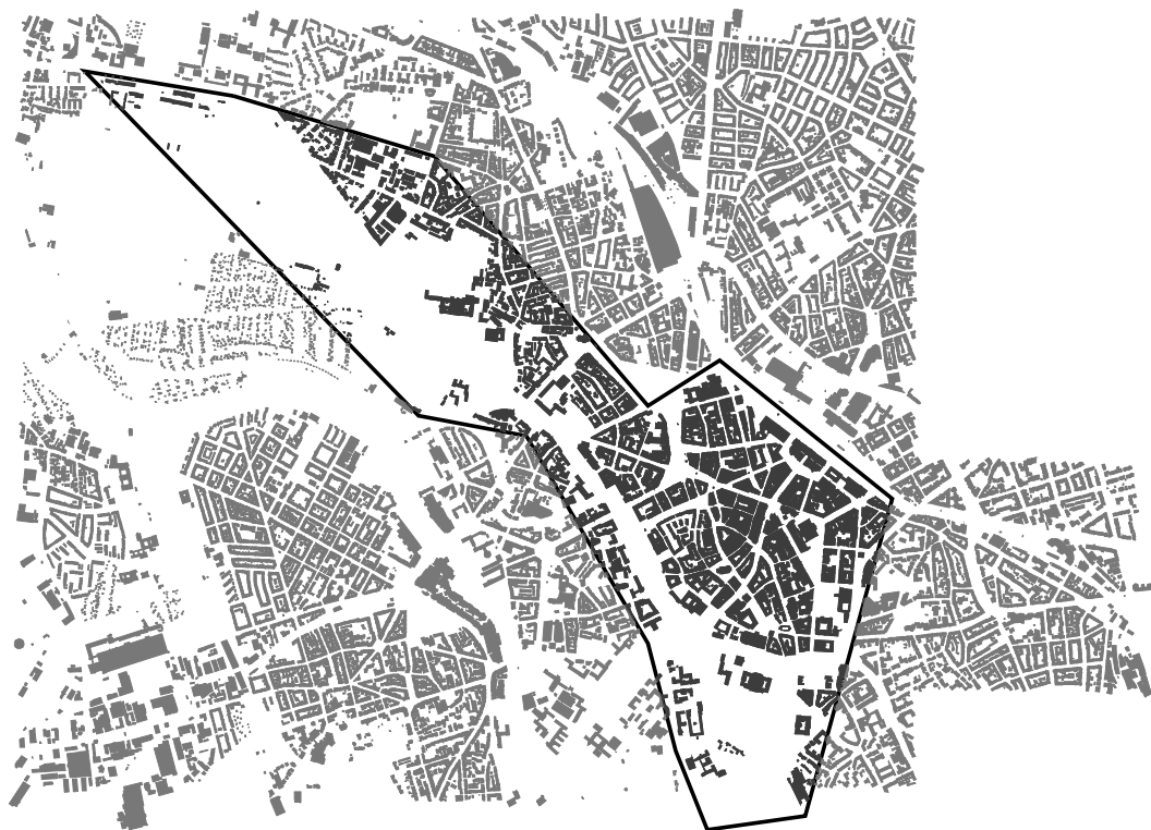
Abbildung 23: Verfügbares Datenmaterial: Gebäude aus der ALK Hannover (dunkelgraues Gebiet, umrandet: Laserscan-Bereich), Maßstab ca. 1:20.000
