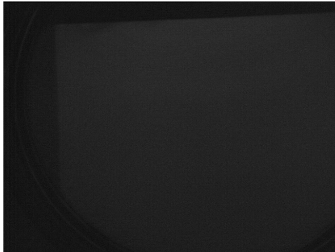
Abb. 80 RHEED-Messung nach einer Siliziumabscheidung bei 550°C. Das RHEED-Bild zeigt keinerlei Struktur.
