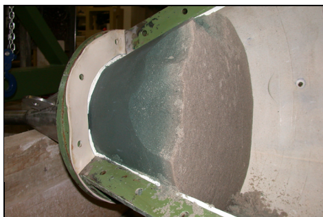
Ansicht des freigelegten Injektionskörpers
