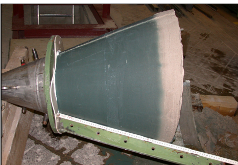
Ansicht des freigelegten Injektionskörpers
