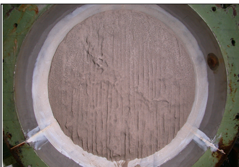
Oberfläche des Injektionskörpers
