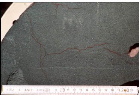
Schnitt durch den Injektionskörper mit Cracks
