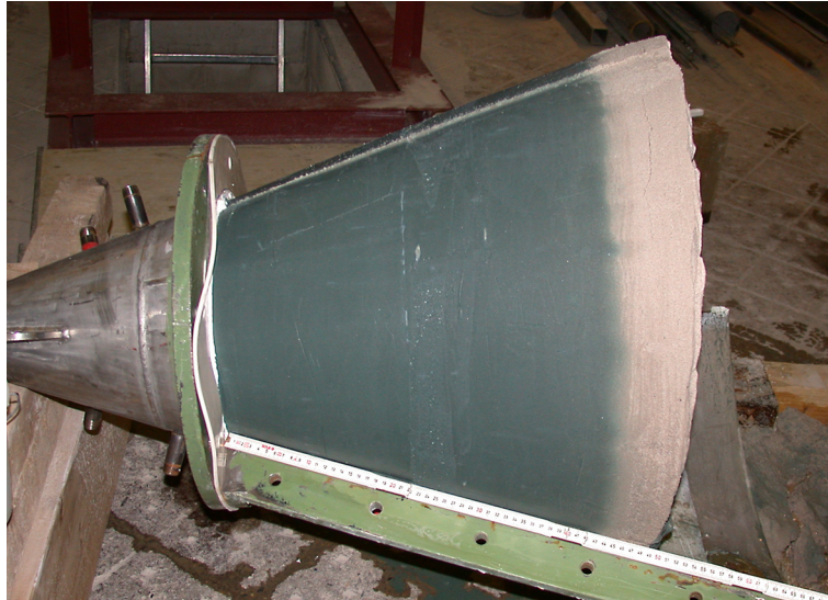
Bild 6.6: Foto eines freigelegten Verpresskörpers
