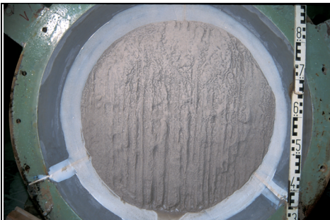
Oberfläche des Injektionskörpers
