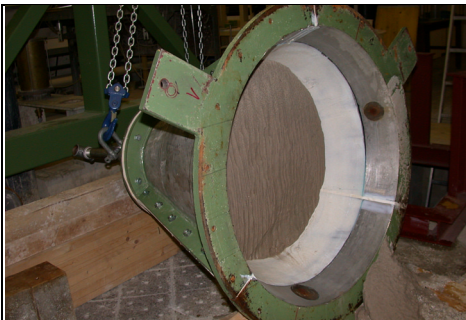
Oberfläche des Injektionskörpers
