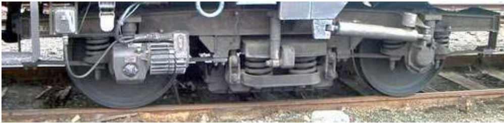
Anlage 7: MD36-Fahrwerk mit Schlingerdämpfern [17] (zu Kapitel 5.1 Entwicklungsgeschichte)
