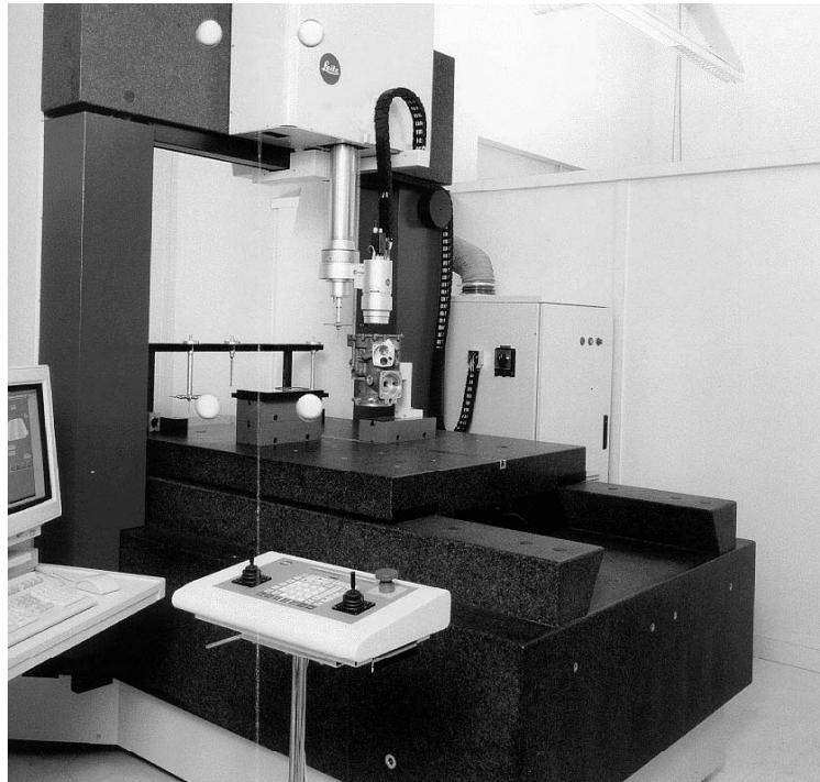
Abbildung 36: Zur Vermessung der rückgefederten Bauteile verwendetes 3D-Koordinatenmessgerät Leitz PMM 864
