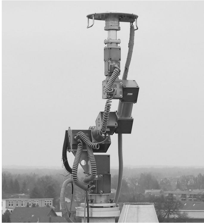
Abbildung 6.9: Roboterarm zur Absoluten Antennen- und Stationskalibrierung.
