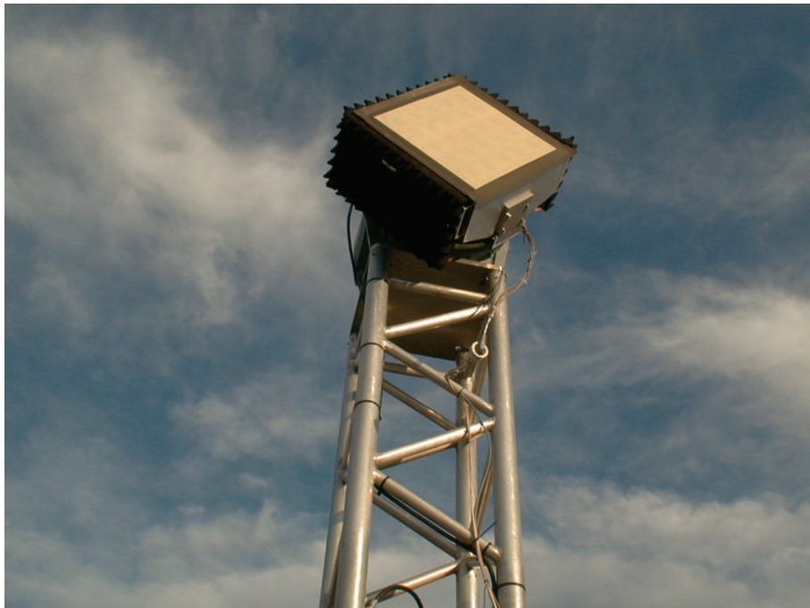
Abbildung B.6: Das komplette L-Band - System auf der Freiraum - Fernfeld - Messanlage des DLR in Oberpfaffenhofen.
