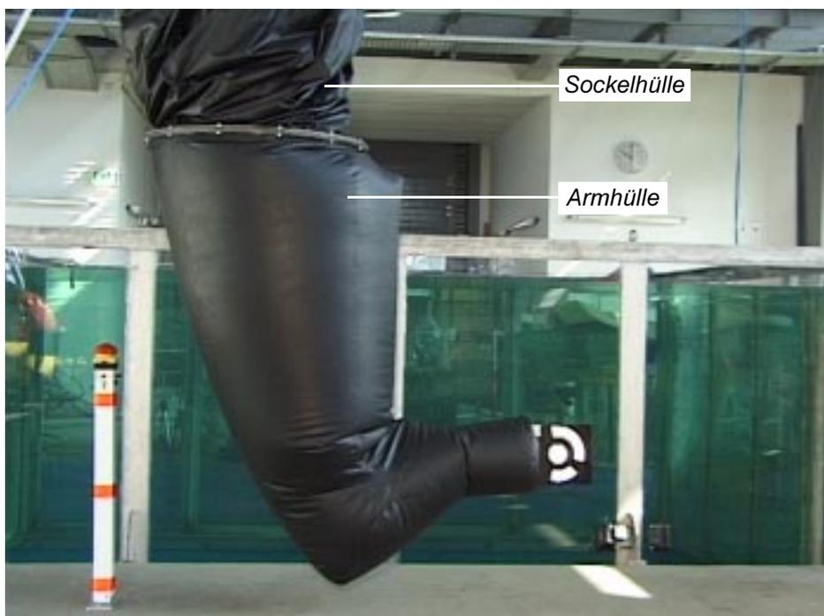
Abbildung 55: wasserdicht eingehüllter Roboter
