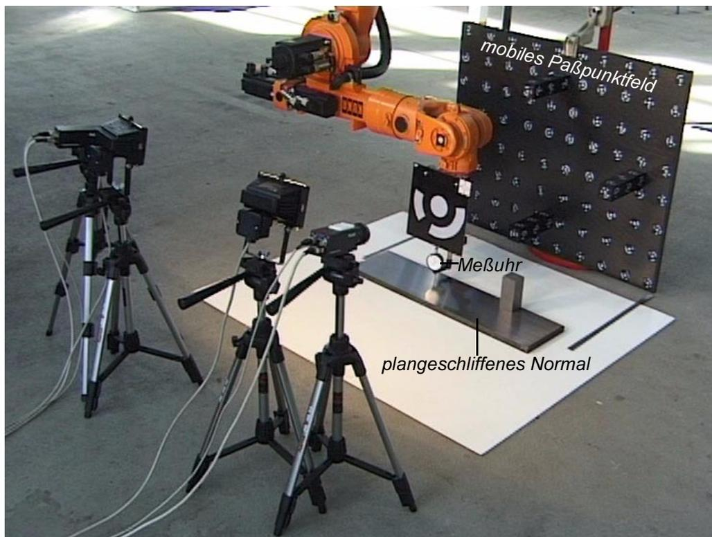
Abbildung 60: mobiler Meßaufbau
