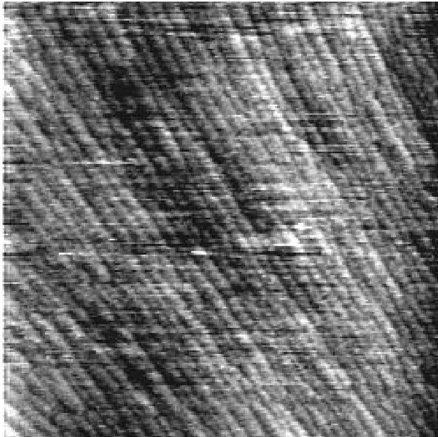
Abbildung 4.9:  $2.5\ \mu\text{m} \times 2.5\ \mu\text{m}$  Topographie-Scan einer Si(111)-Probe nach 10 sec bei  $1350^\circ\text{C}$ . Der Druck stieg während der Prozedur auf  $5 \cdot 10^{-6}$  Pa. Es ist die nahezu regelmäßige Stufenfolge zu erkennen. Die Stufenhöhe liegt zwischen dem Zwei- bis Vierfachen der einfachen Stufenhöhe des Siliziums in [111]-Richtung.
