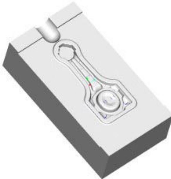
Bild 89: CAD-Modell eines Schmiedewerkzeuges zur Fertigung eines Pleuels.
