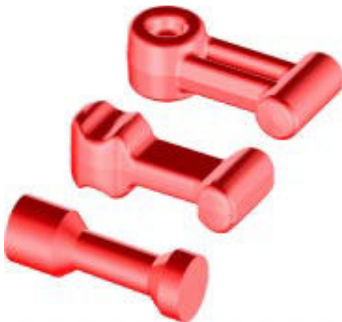
Bild 79: Stadienfolge zur schmiedetechnischen Herstellung des Experimentalteiles /24/.
