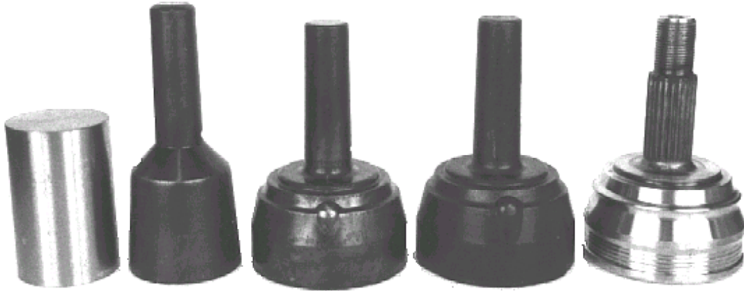
Bild 2: Herstellungssequenz (Stadienfolge) eines präzisionsgeschmiedeten Gleichlaufgelenkes in der Folge Rohteil – Vorform – Zwischenform – Schmiedeteilendform – Fertigteil /51/.
