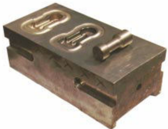
Bild 80: Werkzeug zur Fertigung des Experimentalteiles
