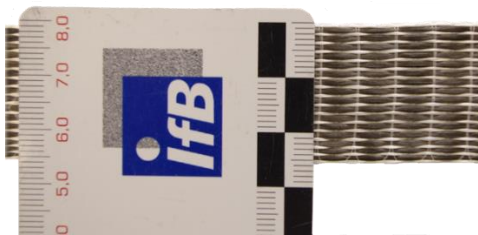
Bild 2: Die Kohlenstofffaserbewehrung in Form eines endlosen, unidirektionalen Bandes.
