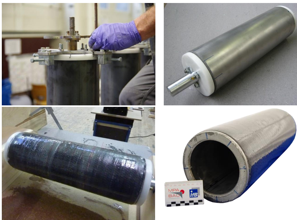
Bild 4: oben links: Einfüllen des Betons mithilfe einer Betonierlanze in den Zwischenraum zwischen den beiden Stahlblechen (Quelle: Scholle et al. 2016a); oben rechts: Probekörper auf Wickeldorn zum Auftragen der Kohlenstofffaserbewehrung; unten links: Probekörper beim Auftragen der Kohlenstofffaserbewehrung; unten rechts: fertiggestellter Probekörper
