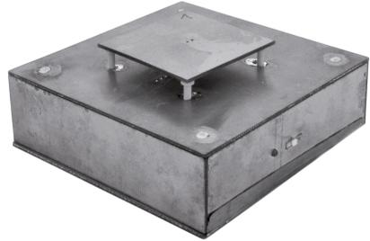
**Abbildung 7:** Testaufbau mit aufgestecktem Subboard ohne Massepfosten
